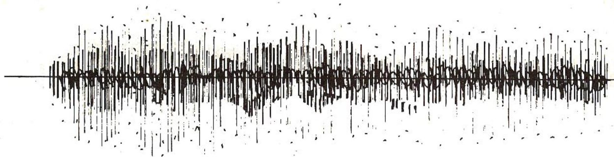
Fig. 5 - Abbiamo voluto osservare sullo schermo dell'oscilloscopio il diagramma relativo al segnale prodotto dal generatore di rumore rosa. Lo abbiamo fotografato e qui riprodotto.
