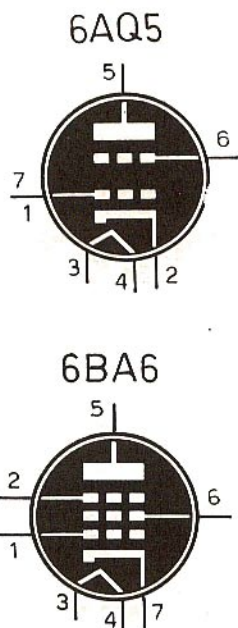
Fig. 4 - Due valvole distinte possono sostituire le due sezioni della valvola compactron 6AL11. La prima di queste (6BA6) è un pentodo; la seconda (6AQ5), pur essendo un pentodo, viene usata in veste di tetrodo.
